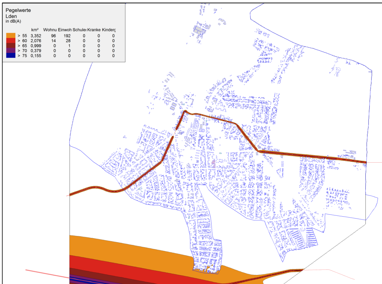
Abbildung 17 Isophonen-Bänder L den aller Schienenverkehrslärmquellen über 55 dB(A)
